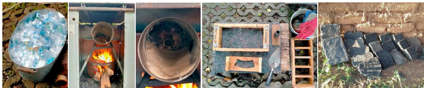
Transformationフロー プラスチック + Sand ⇒ Fire ⇒ 煉瓦 ※日本での取組み例)リサイクルの難しいプラスチック+砂防ダム沈砂+間伐材(水を使用しない)⇒煉瓦・舗装・造園用ブロック(〽)☆
